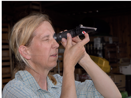
Bestimmung des Zuckerwertes (Oechslegrade) mit dem Refraktometer.
